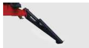
Vérins stabilisateurs avec soupapes de freinage intégrées.
