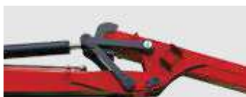
Le mécanisme »K« à quatre articulations assure les excellentes performances de travail de la grue.
