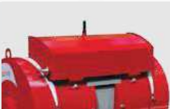
Grand réservoir d'huile pour le système hydraulique et l'entraînement des poulies
