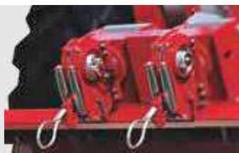
Poulies de commande compactes qui tournent librement et sans enchevêtrement de tuyaux hydrauliques. Elles facilitent l'extraction du câble hors du tambour et elles assurent l'enroulement ferme et uniforme du câble sur le tambour
